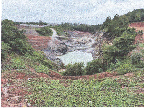
รูปที่ 1 พัฒนหาน้ำเหมืองเป็นแบบขั้นบันได
